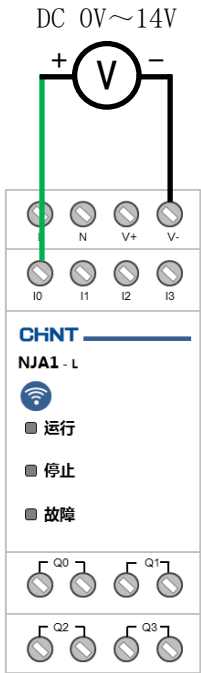
图 3 模拟量输入接线图
