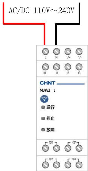
图 1 供电电源接线图
